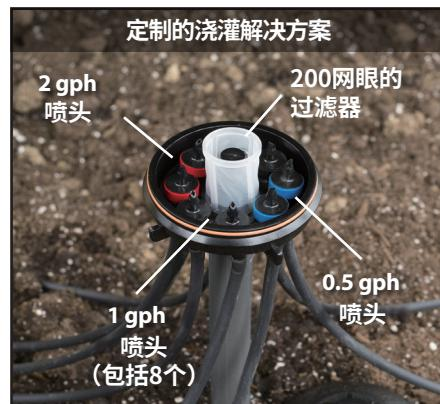
每个端口都能通过安装流量控制喷头来配置成Xeri-Bird™类型。以上所示就是0.5、1.0和2.0 gph的Xeri-Bug喷头的结合。下图就是可用喷头的清单。
