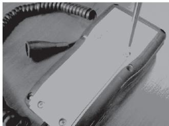
旋松螺丝，并将现场发射器底壳拆下。
