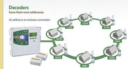
您的ESP-LXD控制器与地里的解码器使用两线方式线路连接。这条线路携带电压和信息。
