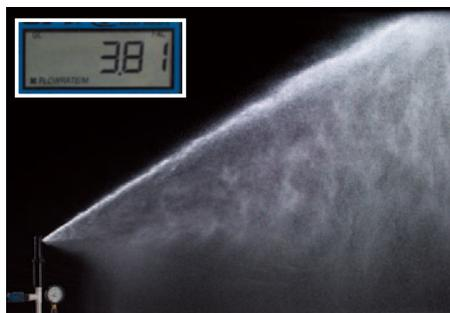
无PRS的竞争对手的旋转喷头，3加仑/分钟的喷嘴，进口压力5.4巴。没有使用PRS，流量上升至3.81加仑/分钟。
