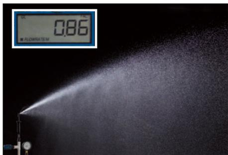
1800PRS散射喷头，15Q喷嘴，进口压力5.4巴。
