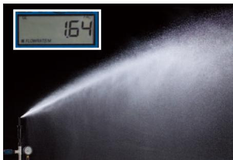
无PRS的竞争对手的散射喷头，15Q喷嘴，进口压力5.4巴。
