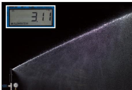
5000PRS旋转喷头，3加仑/分钟的喷嘴，进口压力5.4巴。
