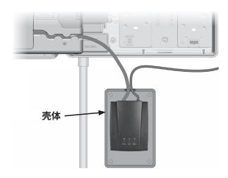
9 将wifi适配器连接线和电源接头插入到适配器单元中,并安全地盖好外壳盖子。
