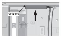
请注意:请不要让wifi适配器直接接触到控制器的连接组件,或者其他临近位置的接线组件。
