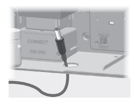
将wifi适配器的连接线插入到NCC盒体背面的连接 插孔中。
