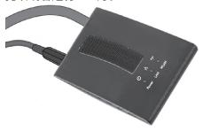
在控制器柜体中选择一处可以安装适配器的地方。在 紧邻位置的表层贴上一段velcro带子,并安装上适配 器。
