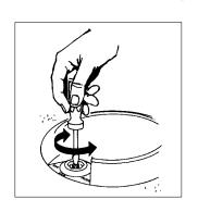
要调节压力调节器,使用平头螺丝刀旋转喷头顶端的选择器中心的调节螺丝。
